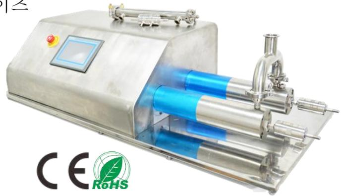
PilotPump 시리즈 전기 위생 고압 펌프는 터치 스크린으로 작동하고 프로그램에 의해 지능적으로 제어되는 장비입니다. 지방 에멀전, 리포솜, 나노 현탁액, 지질 마이크로 스피어, 나노 에멀전, 유제품, 주입 용액, 세포 파괴, 주스 균질성, 정밀 화학 공학, 염료 등의 산업 파일럿 준비에 사용할 수 있습니다. 최대 작동 압력은 20,000 Psi/1500 Bar 입니다. 매질과 접촉하는 모든 부품은 FDA 승인 위생재료를 사용하며, 316L 스테인리스강, 17-4PH 스테인리스강, 티타늄합금, 탄화텅스텐, PTFE, UHMWPE.
